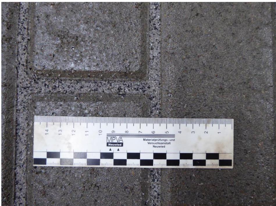
Diese fertigen Flächen lagerten vor der Durchführung der Verschiebeversuche über einen Zeitraum von 7 Tagen im Hallenklima bei ca. 18°C bis 20°C.
