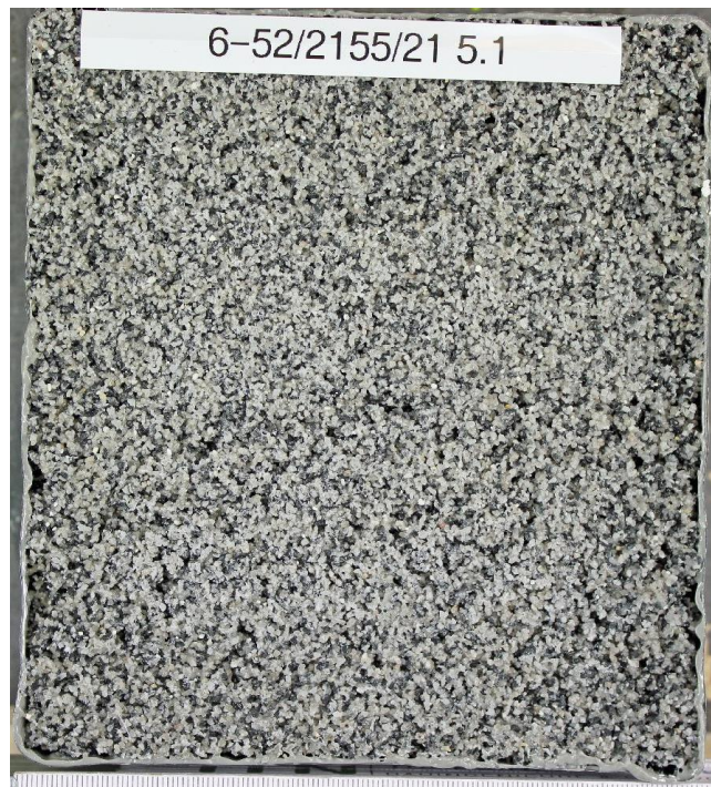
Bild 11: Probe 1.2 nach der Befrostung
