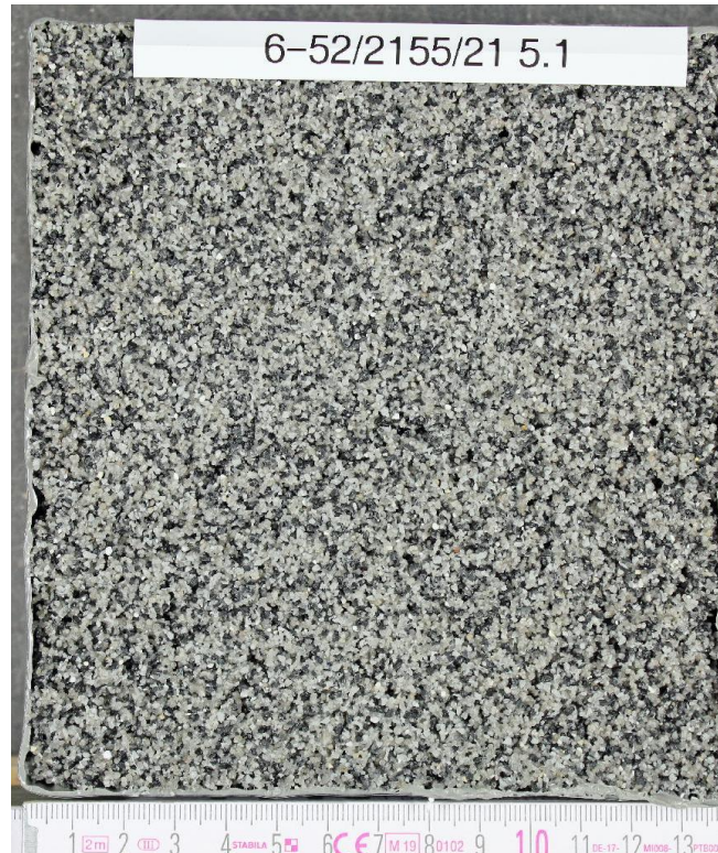
Bild 11: Probe 1.2 nach der Befrostung
